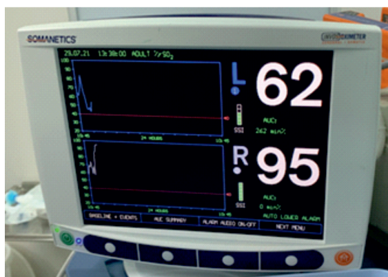
Рисунок 3. Аппарат оксиметрии головного мозга «Somanetics»
